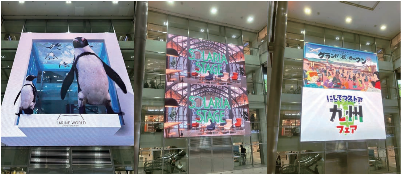
■ Sansan株式会社 | CYBER VISION: [屋内用] COB P1.875mm W12,000×H2,362.5(mm) / DiSiクラウド
