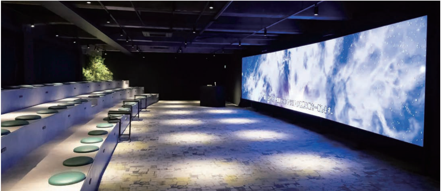
■イオンモール豊川 | CYBER VISION: ①滝サイネージ [屋内用] P4mm W1,792×H14,336 (mm) / ②サウスコート2F 410インチ [屋内用] P6mm W9,024×H5,088 (mm) / ③層間LEDビジョン: A [屋内用] P4mm W6,656×H1,280 (mm) B [屋内用] P4mm W1,008×H1,536 (mm) / ④キッズゲーム搭載大型LEDビジョン: [屋外用] P6mm W8,880×H5,040 (mm) / ⑤info: CUBE VISION [屋内用] P4mm 256mm角
