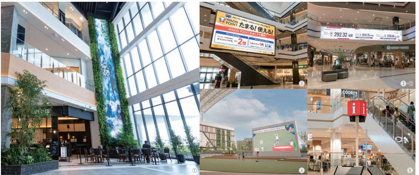
■イオンモール豊川 | CYBER VISION: ①滝サイネージ [屋内用] P4mm W1,792×H14,336 (mm) / ②サウスコート2F 410インチ [屋内用] P6mm W9,024×H5,088 (mm) / ③層間LEDビジョン: A [屋内用] P4mm W6,656×H1,280 (mm) B [屋内用] P4mm W1,008×H1,536 (mm) / ④キッズゲーム搭載大型LEDビジョン: [屋外用] P6mm W8,880×H5,040 (mm) / ⑤info: CUBE VISION [屋内用] P4mm 256mm角
